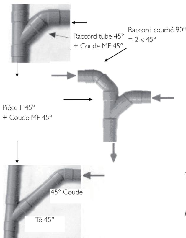
Si un tuyau rejoint la conduite principale par en dessous, un raccordement comme ci-dessous est nécessaire.
