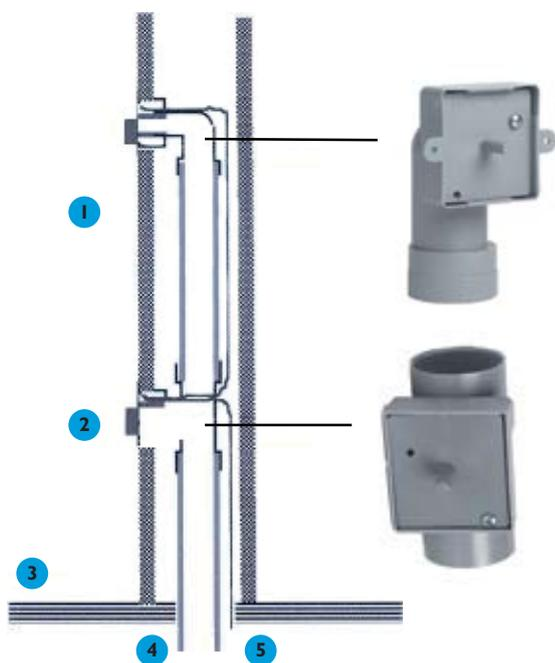
Raccord coudé 90° Millennium (coude en équerre) avec protège-plâtre intégré
