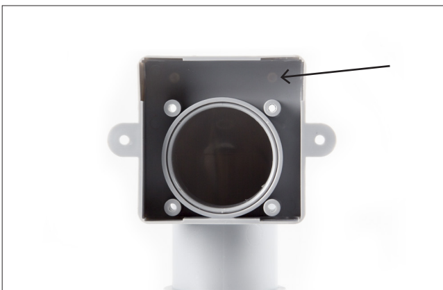
Gebogen aansluitstuk voorzien van 12V-kabel. Steek de kabel door het geboorde gat in de achterzijde van het gebogen aansluitstuk. Maak de knoop in de 12-V kabel om te vermijden dat deze terugvalt & voorzie extra draad om na de bepleistering eenvoudig te kunnen aansluiten op de vacuümaansluiting. Plaats het pleisterplaatje indien nodig terug.
